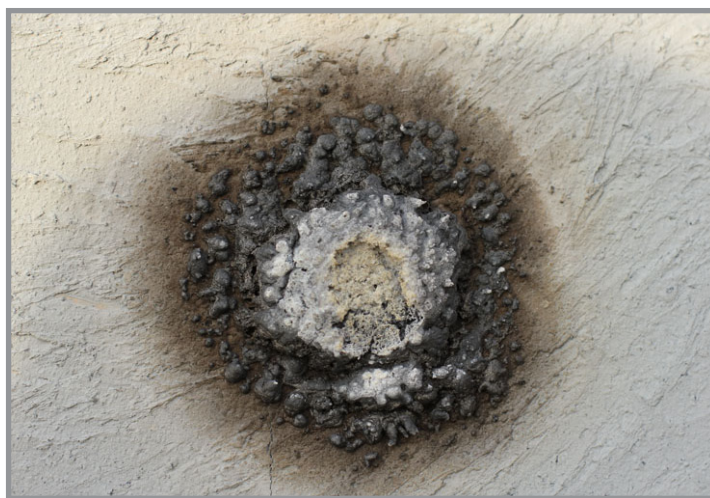
Рис. 2. Испытание образца покрытия из краски с добавлением нанопорошка шунгита открытым пламенем температурой 1700°C
