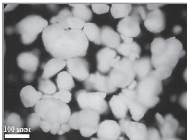
Рис. 5. Суспензионный ПВХ
