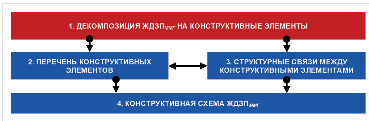
Рис. 2. Декомпозиция железнодорожного земляного полотна на многолетнемерзлых грунтах на конструктивные элементы
