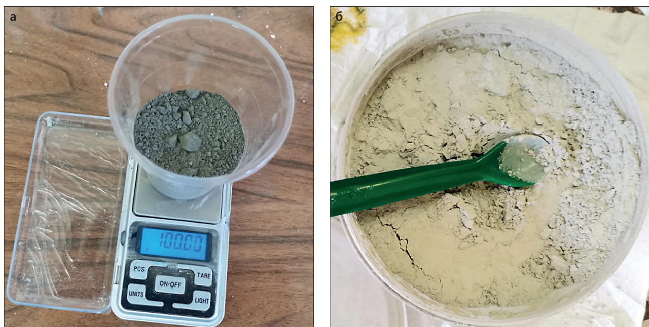
Рис. 4. а) Взвешивание портландцемента на электронных весах; б) Пример одного из компонентов добавки (нанопорошок карбида кремния (SiC))
