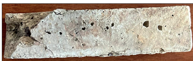
Рис. 13. Разрушение керамического композита при содержании баритового порошка 50%
