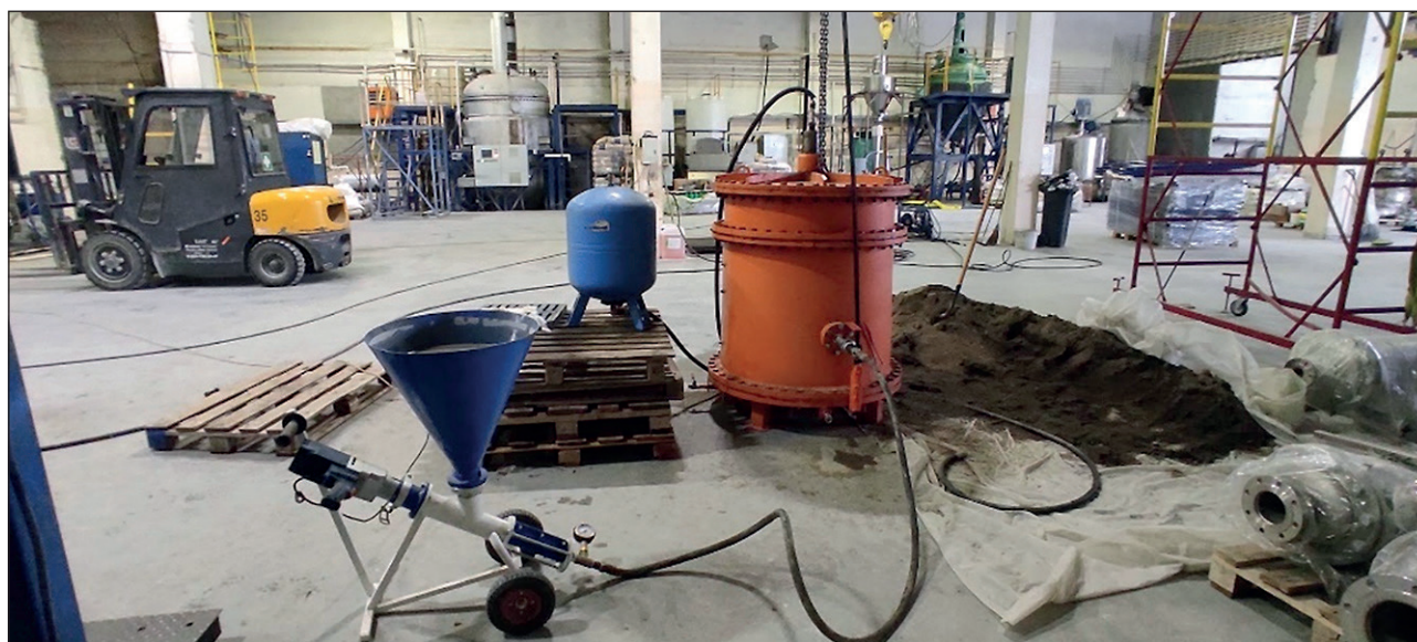
Рис. 6. Установка большой VIM – модели на производственной площадке для моделирования процессов нагнетания
