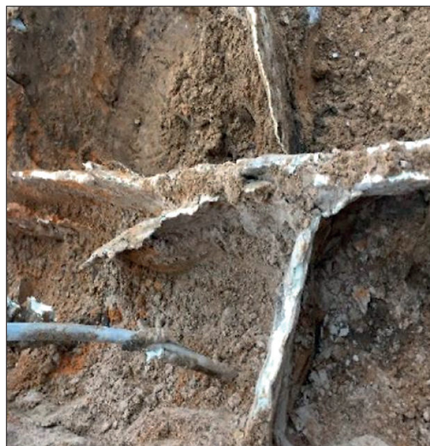
Рис. 9. Сеть каналов распространения полимерного состава на полиуретановой основе от точки инъекции
