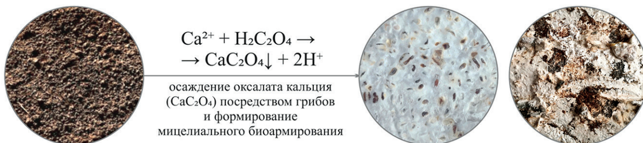
Рис. 6. Механизм оксалатно-карбонатной биоминерализации с участием грибов Pleurotus ostreatus : формирование \text{CaCO}_3 и \text{CaC}_2\text{O}_4 , мицелиального «биоармирования» и упрочнение грунтового основания
