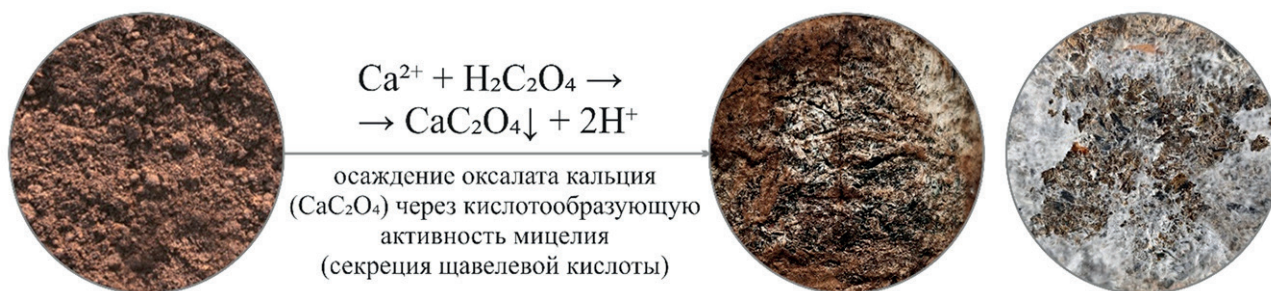
Рис. 5. Механизм оксалатной биоминерализации на основе секреции щавелевой кислоты с участием грибов: формирование \text{CaC}_2\text{O}_4 и стабилизация грунтового основания
