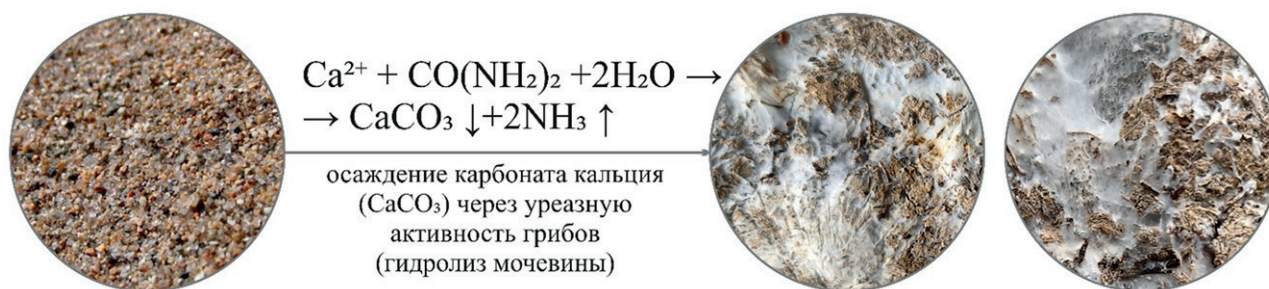
Рис. 2. Механизм карбонатной биоминерализации посредством гидролиза мочевины и уреазной активности грибов: формирование \text{CaCO}_3 и биоцементация образцов речного песка
