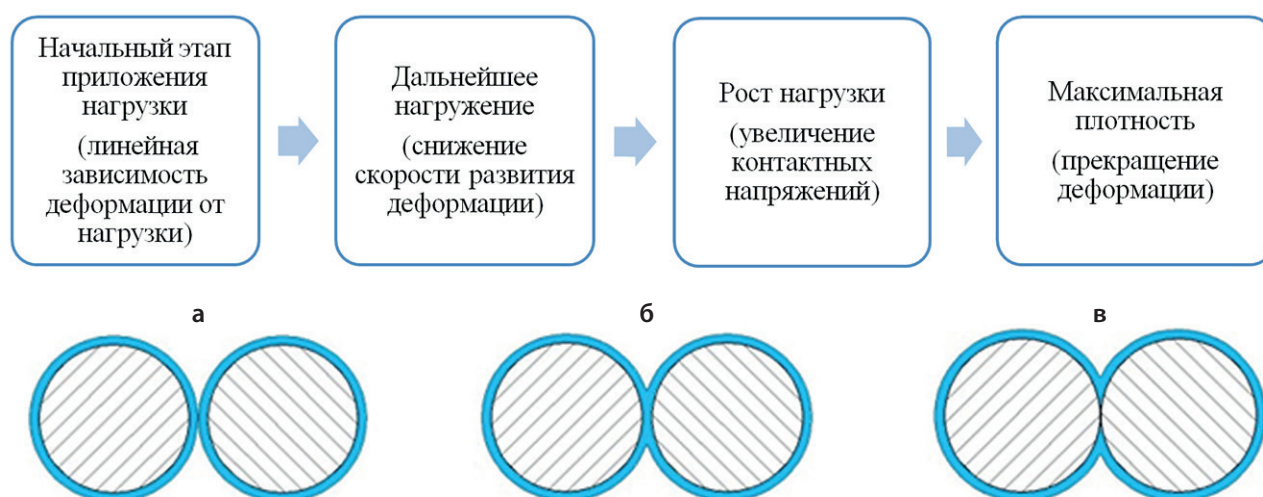
Рис. 3. Физико-химическая схема процессов при замачивании грунта
