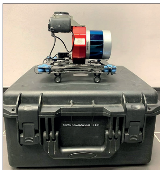
Рис. 1. Общий вид оборудования, использованного в исследовании (слева – БВС, справа – воздушный лазерный сканер на подвесе)
