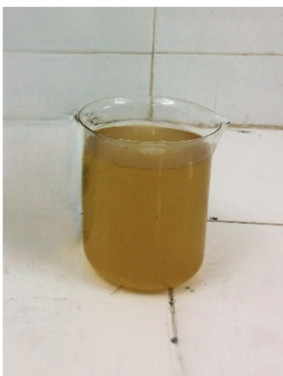
Рис. 9. Смесь суперпластифицирующей добавки и активирующего раствора
