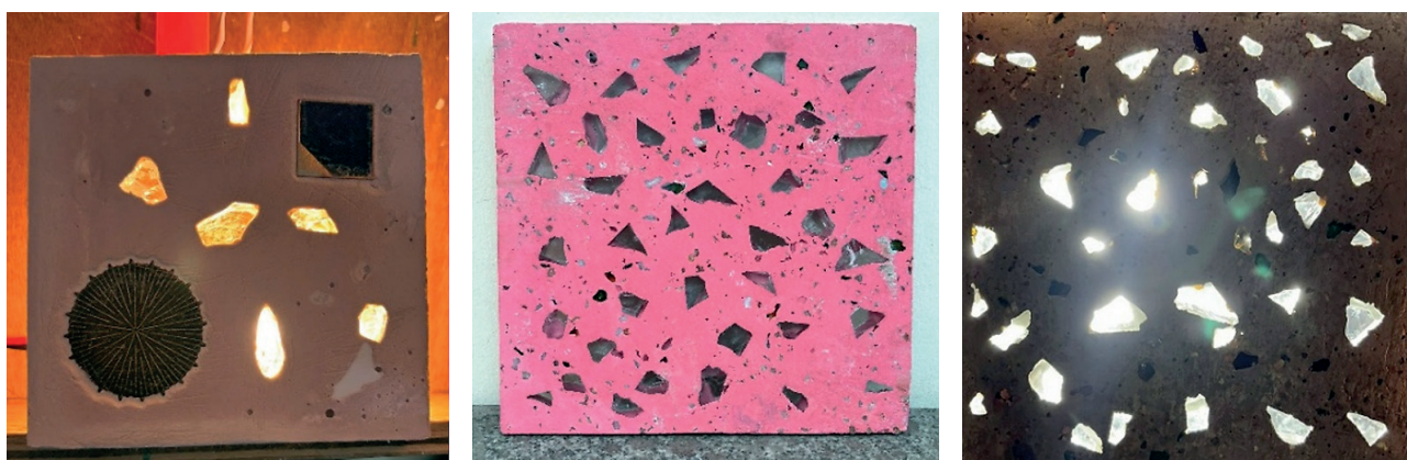
Рис. 19. Некоторые изделия из светопропускающего бетона
