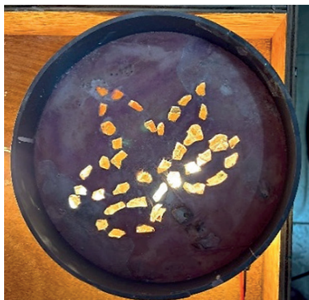
Рис. 13. Подготовка форм и заливка бетонной смеси для формования изделий
