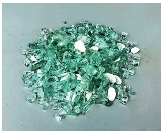
Рис. 5. Частицы стекольных отходов после дробления
