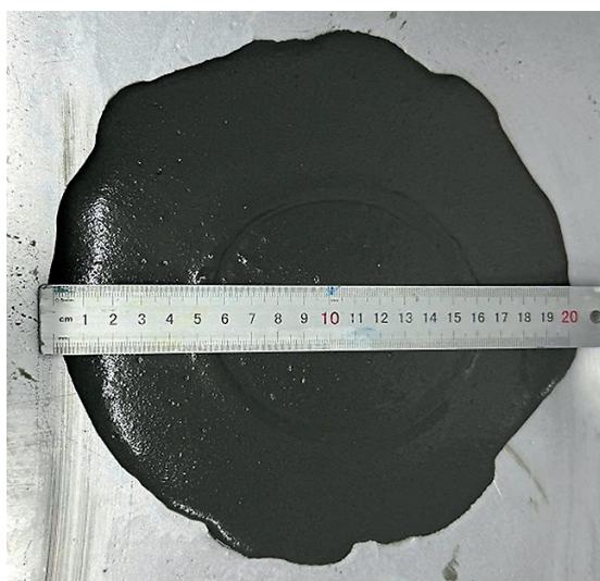
Рис. 14. Измерение расплыва конуса бетонных смесей
