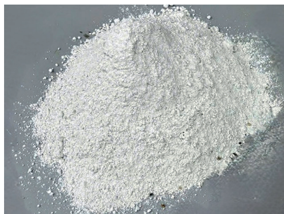
Рис. 3. Тонкомолотый доменный гранулированный шлак металлургического завода «Хоа Фат»
