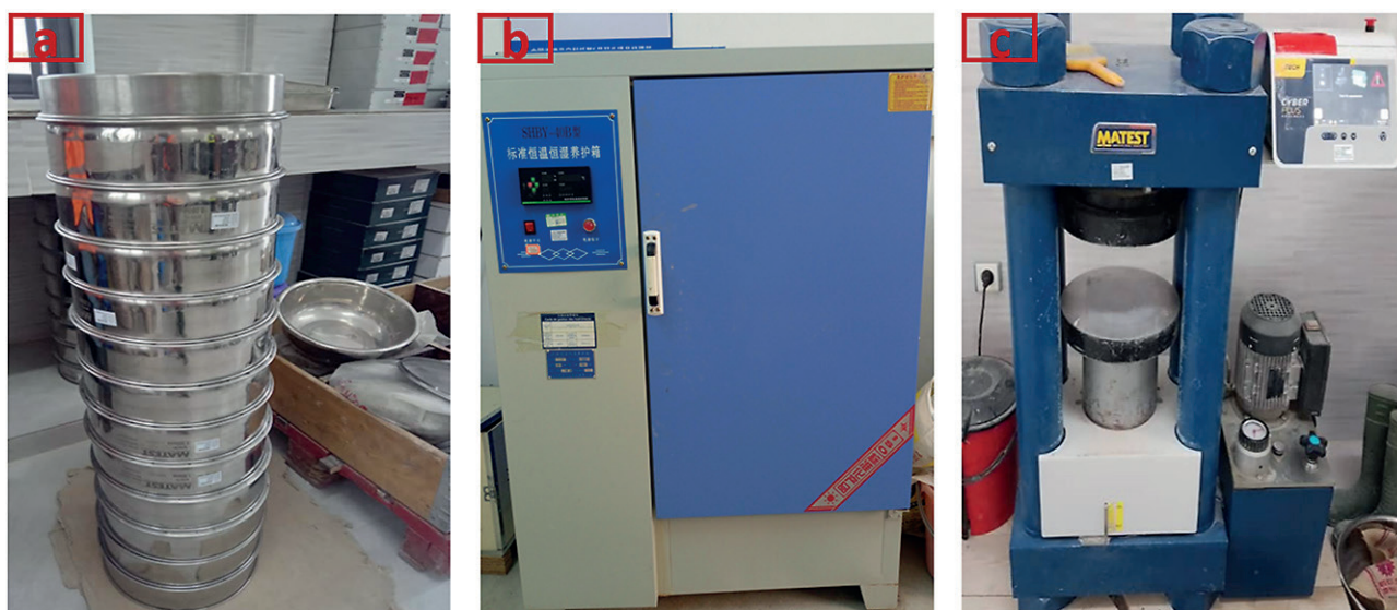
Рис. 3. а – серия сит; б – печь; с – машина для испытания на сжатие
