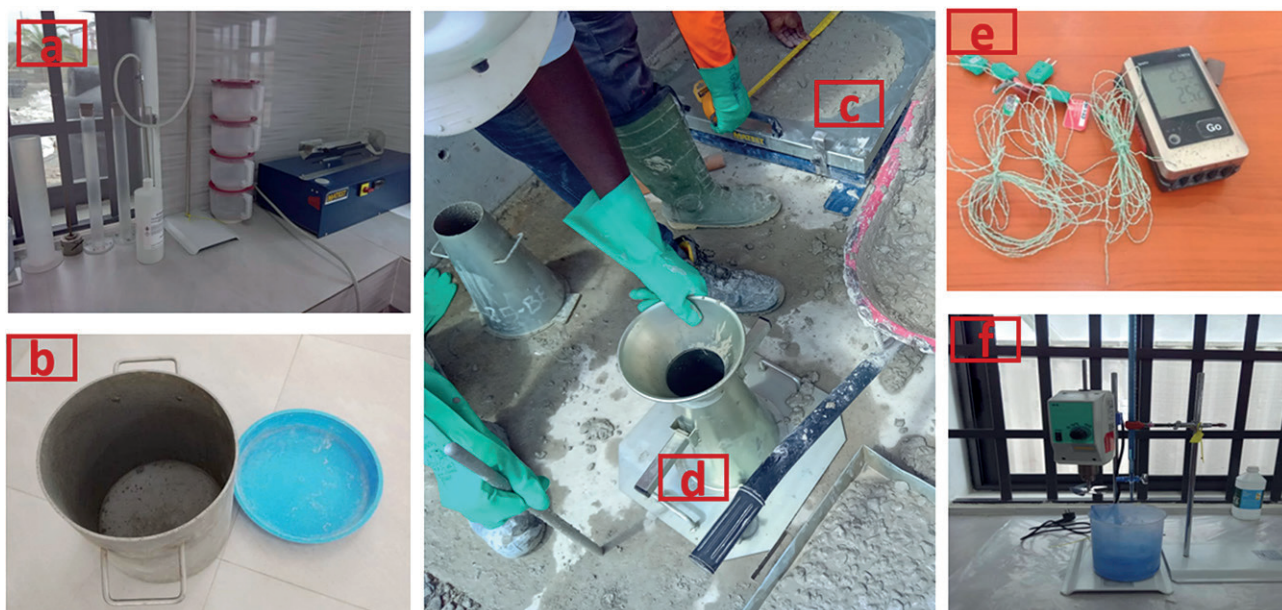
Рис. 1. а – прибор для испытания песчаного эквивалента; б – прибор для испытания на свободное выделение воды; с – стол для испытания текучести; d – испытание осадки (испытание конусом Абрамса); е – термопара; f – прибор для испытания метиленовым синим
