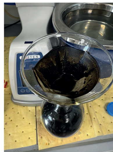
Рис. 9. Процесс выделения нефтяной составляющей из пробы «Большой пруд точка № 2 (отметка +3,3 м)»
