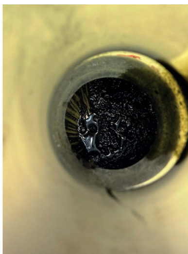
Рис. 9. Процесс выделения нефтяной составляющей из пробы «Большой пруд точка № 2 (отметка +3,3 м)»
