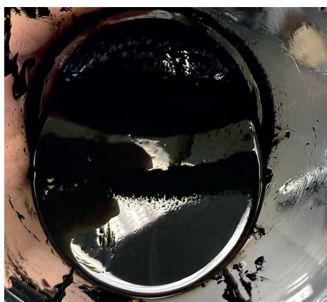
Рис. 14. Разделение пробы после центрифугирования смеси «проба + Нефрас С2 80 1:2»
