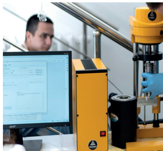
Рис. 7. Определение динамической вязкости пробы
