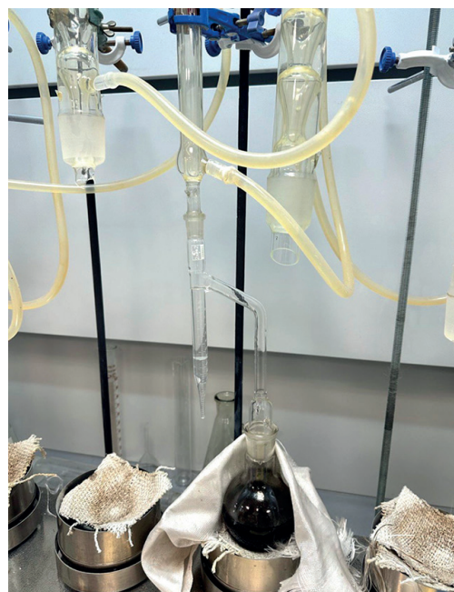
Рис. 3. Определение содержания воды методом Дина-Старка
