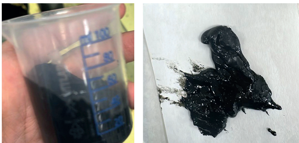
Рис. 12. Внешний вид пробы после центрифугирования смеси «проба + дизельное топливо»
