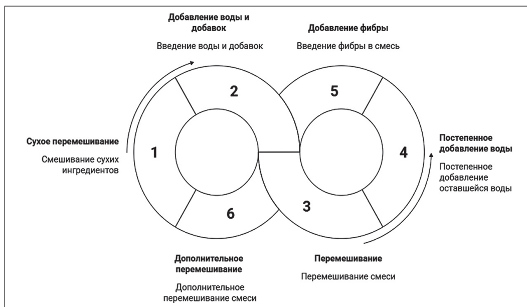
Рис. 4. Цикл приготовления бетонной смеси
