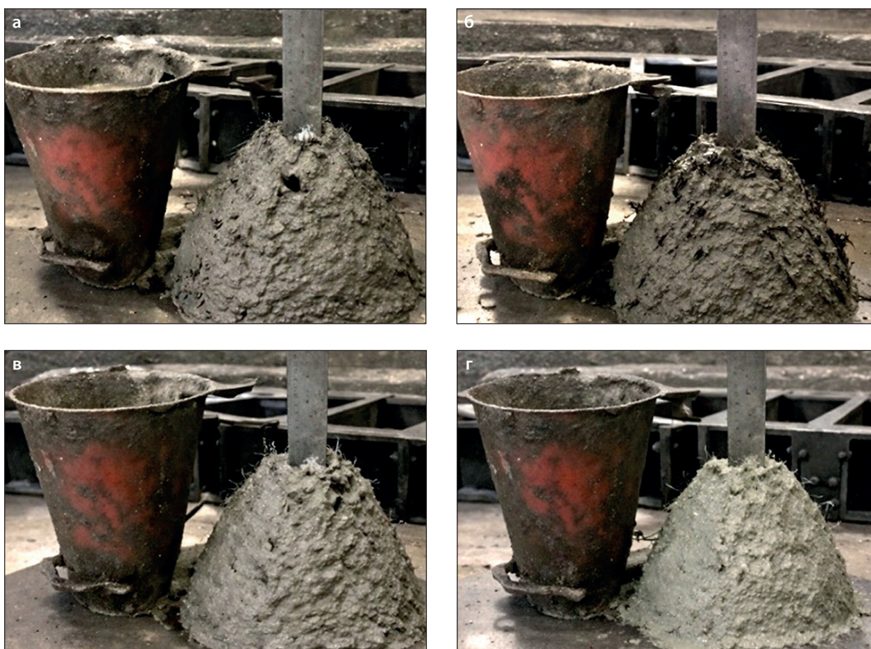
Рис. 5. Внешний вид бетонных смесей после определения осадки конуса: а) смесь со стальной фиброй; б) смесь с базальтовой фиброй; в) смесь с полипропиленовой фиброй; г) смесь со стеклянной фиброй
