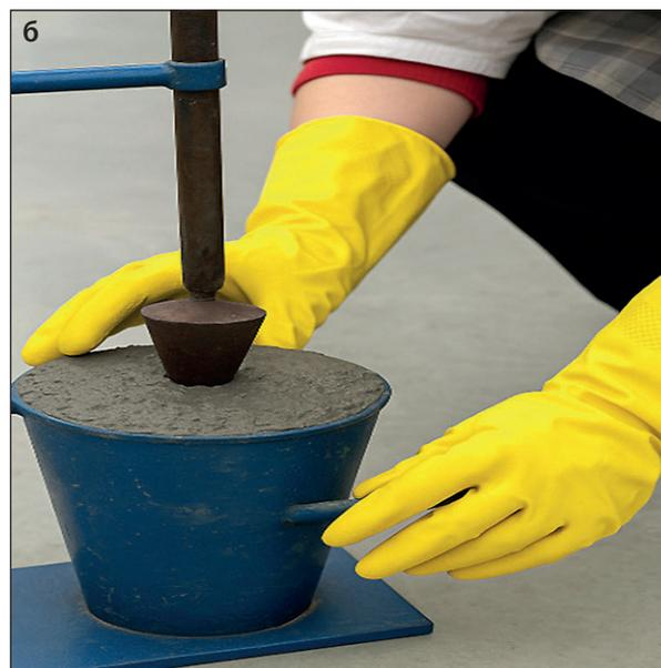
**Рис. 1.** Определение реологических свойств бетонной смеси: а – определение осадки конуса базового состава (ОК), б – определение подвижности смеси контрольных, экспериментальных составов
