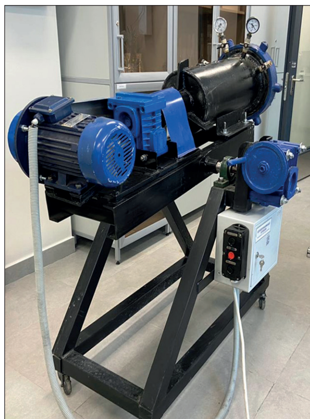
Рис. 2. Бетономешалка для получения смеси под давлением
