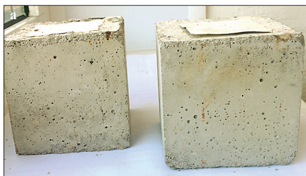
Рис. 2. Внешний вид образцов после пропаривания состава: а) контрольного; б) опытного
