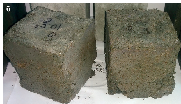
Рис. 2. Внешний вид образцов после пропаривания состава: а) контрольного; б) опытного
