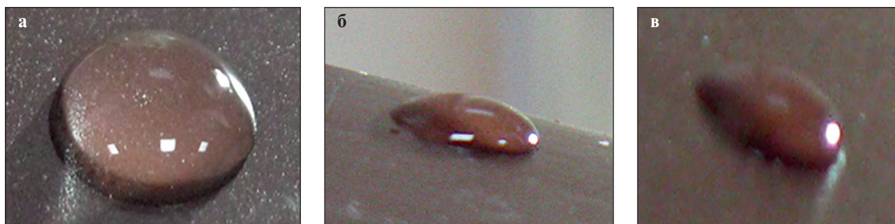
Рис. 5. Фото капли воды на поверхности антиобледенительного покрытия на металлической поверхности: а — в исходном состоянии; б — через 1 сек скатывания; в — через 2 сек скатывания
