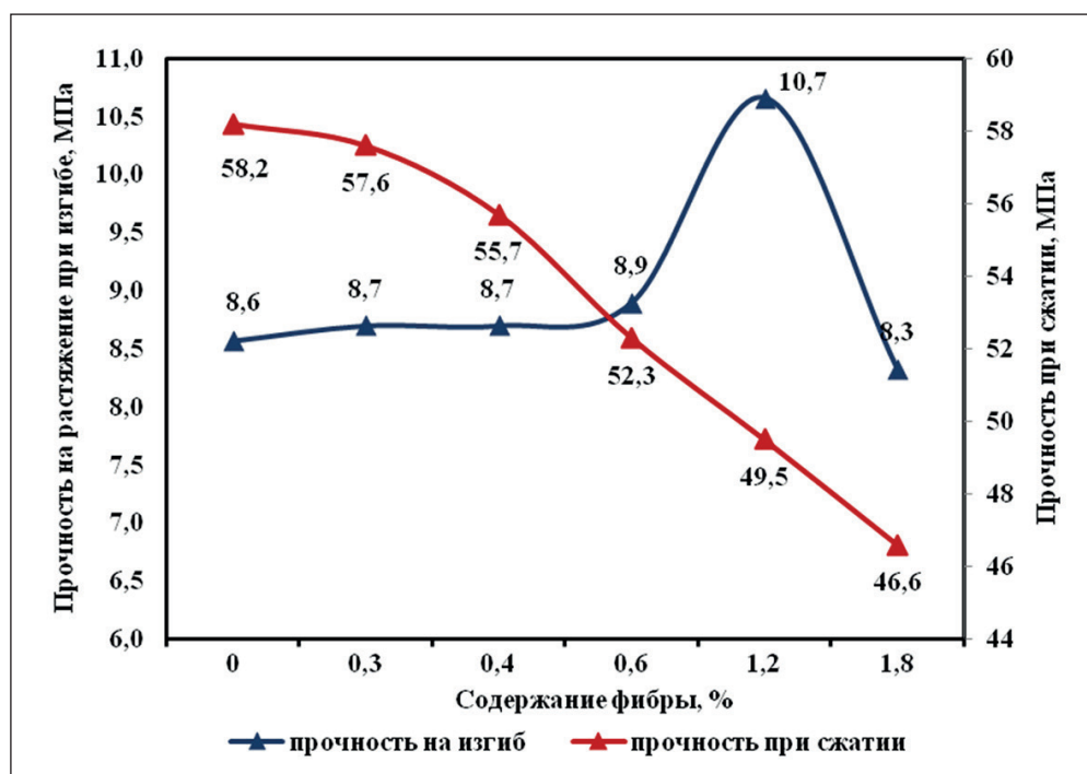
Рис. 11. Исследование влияния ПВХ фибры на прочность при сжатии и на растяжение с изгибом в возрасте 28 сут.
