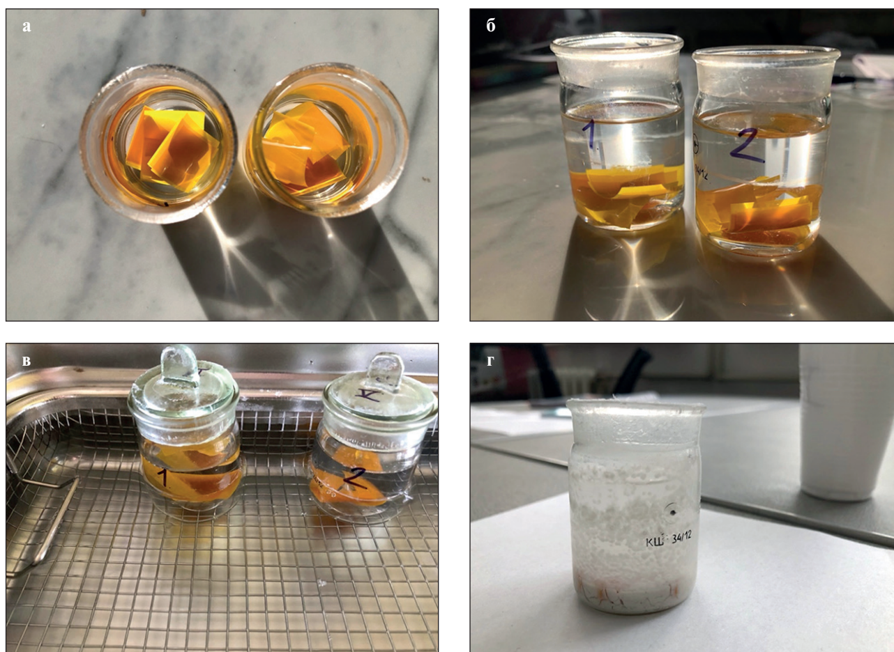
Рис. 2. Процесс протекания гидролиза. Подготовка проб (а, б), процесс гидролиза (в), результат гидролиза (г)
