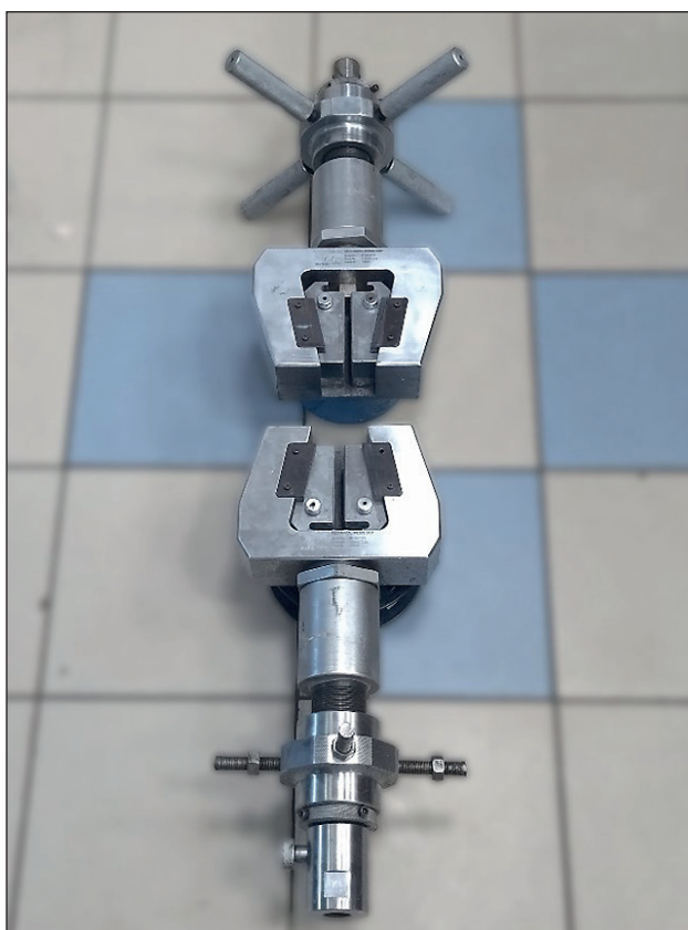
Рис. 2. Внешний вид захватов для испытаний на растяжение
