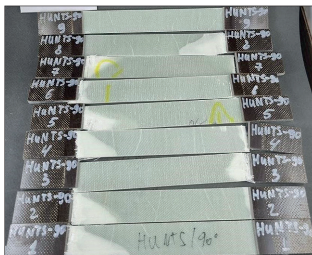
Рис. 3. Фотоиллюстрация образцов из ПКМ на основе стеклоткани Т-10 и связующего Huntsman, направление армирования 90° до и после испытаний на растяжение
