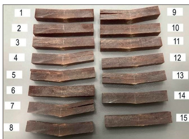
Рис. 14. Фотография образцов из ПКМ на основе стеклоткани Т-10 и связующего ЭД20, направление армирования 0^\circ до и после испытаний на межслойный сдвиг
