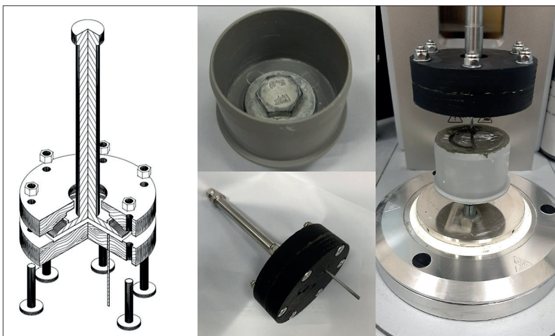
Рис. 2. Схема и фотографии измерительной системы для контроля кинетики схватывания минеральных вяжущих
