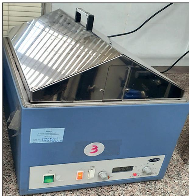
Рис. 2. Ванна для выдержки образцов цемента в воде при атмосферном давлении и температуре нагрева 60°C (140°F)
