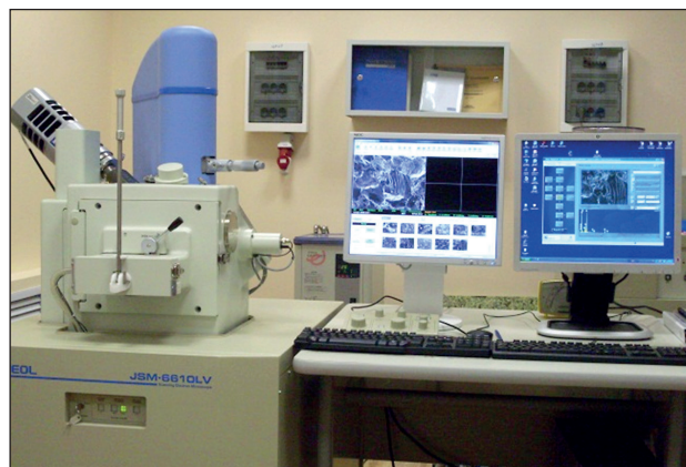
Рис. 1. Внешний вид растрового электронного микроскопа JEOL JSM-6610LV
