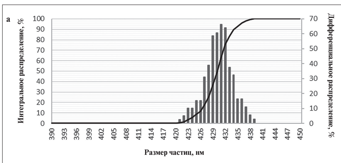
Рис. 4. Кривые объёмного распределения агрегатов Аэросила: а) до внесения индивидуальной добавки; б) после внесения индивидуальной добавки; в) после внесения индивидуальной добавки и обработки ультразвуком
