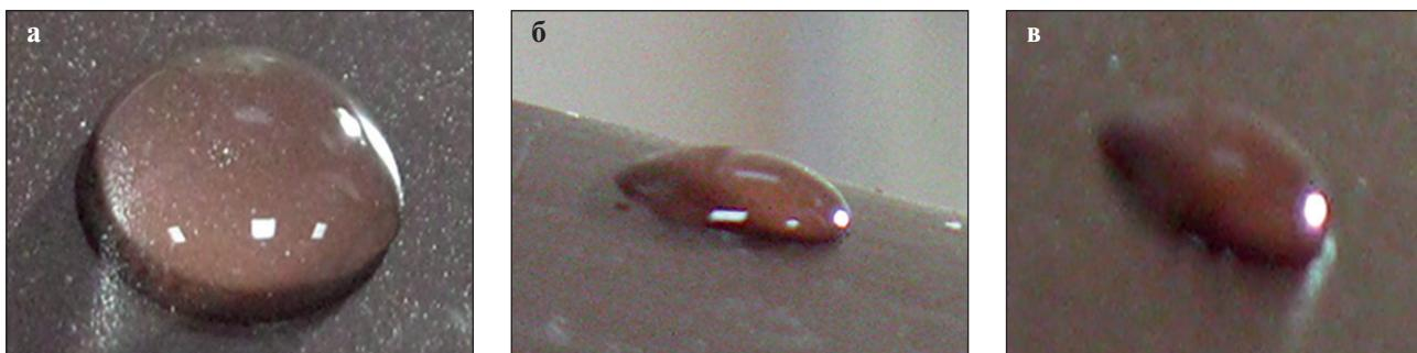
Рис. 5. Фото капли воды на поверхности антиобледенительного покрытия на металлической поверхности:
