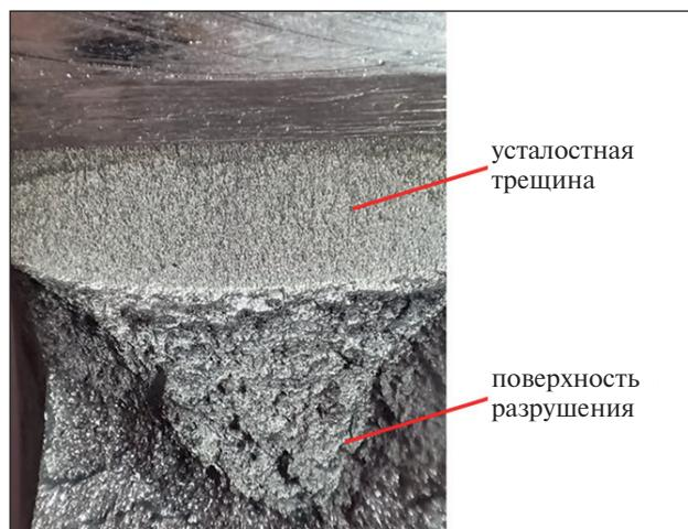
Рис. 5. Поверхность образца с пророщенной трещиной, шероховатость которой измерялась профилометром TR200
