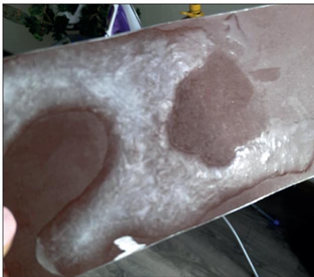
Рис. 7. Фото изображения скатывания льда с гидрофильной поверхности (температура замораживания  $-10^{\circ}\text{C}$ )
