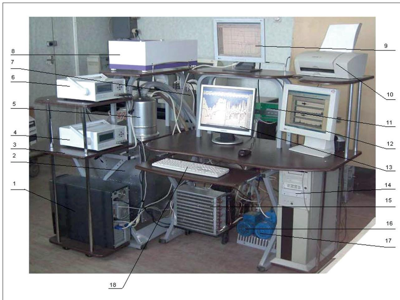
Рис. 4. Внешний вид БЭТА-анализатора:
