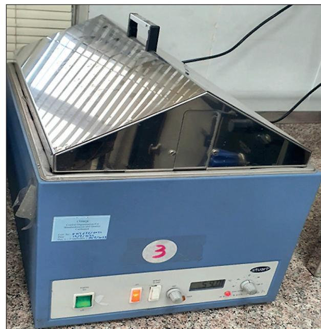
Рис. 2. Ванна для выдержки образцов цемента в воде при атмосферном давлении и температуре нагрева  $60^\circ\text{C}$  ( $140^\circ\text{F}$ )
