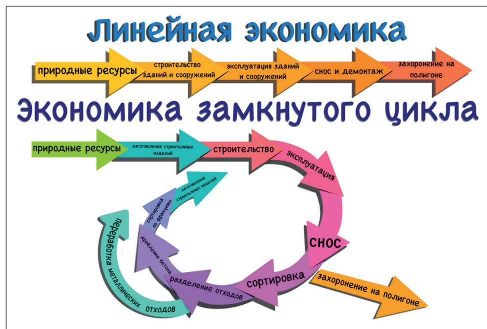
Рис. 1. Отличие линейной экономики и экономики замкнутого цикла на примере переработки лома бетона и железобетона
