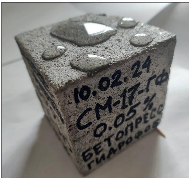
Рис. 2. Вибропрессованный кубик из жёсткого бетона на лиофобном золе «ВИБРОФИНИШ СМ-17-ГФ» с расходом 0,05% в возрасте 10 суток
