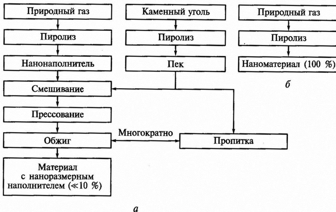
Рис. 4. Технологические схемы производства углеродных наноматериалов:
