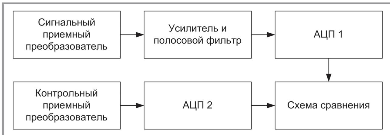
Рис. 1. Устройство регистрации сигналов АЭ
