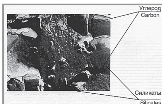
Рис. 2. Структура шунгитовой породы в растровом электронном микроскопе: область сканирования – 100х100 мкм, разрешение – 0,3 нм, увеличение – 500000 раз. Стрелками показаны силикатный каркас из мелкодисперстного кварца размерами 1...10 мкм и равномерно распределенный углерод [4]
