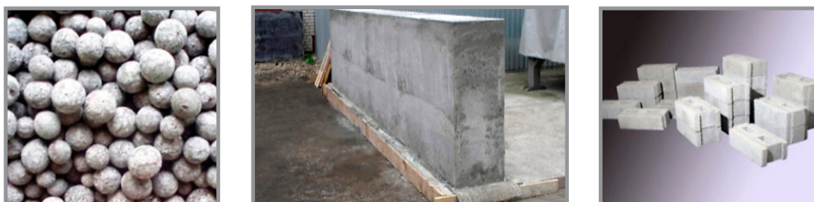
Рис. 1. Гранулированное пеностекло и бетонные изделия из бетона на его основе
