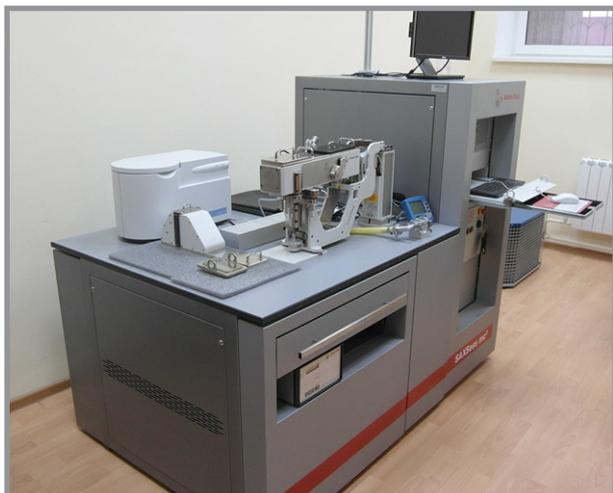
*Рис. 2. Малоугловой рентгеновский дифрактометр «SAXSess» для исследования размера, формы и внутренней структуры нанобъектов*
