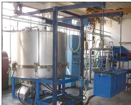
**Способ получения.** Газофазное химическое осаждение (каталитический пиролиз-CVD) углеводородов ( $C_xH_y$ ) на катализаторах (Ni/Mg) происходит при атмосферном давлении и температуре  $580\div 650^\circ\text{C}$ . Время процесса –  $10\div 80$  мин.
