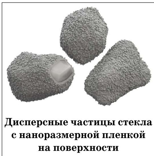
Суть новой технологии состоит в том, что измельченное битое стекло смешивается с раствором специально подготовленных жидких реагентов, которые обеспечивают модификацию поверхности стеклянных гранул, образуя на них наноразмерные пленки толщиной 100–120 нм. Дальнейшая термообработка полученных материалов приводит к синтезу стекла без применения вспенивателя, который необходим при классической технологии производства подобных продуктов.
