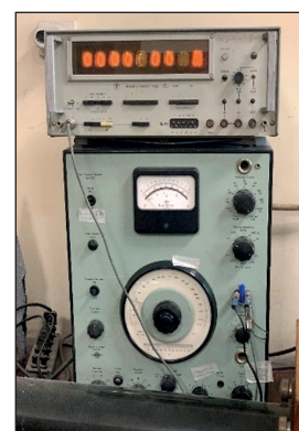
Рис. 6. Прибор для проведения испытания по определению звукопоглощения и образцы испытуемых материалов
