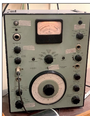
Рис. 6. Прибор для проведения испытания по определению звукопоглощения и образцы испытуемых материалов
