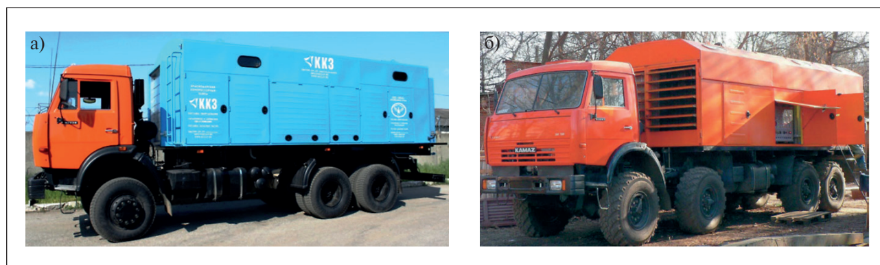
Рис. 10. Азотная станция ТГА-5/10 (а) и пожарный автомобиль ККЗ (б)
