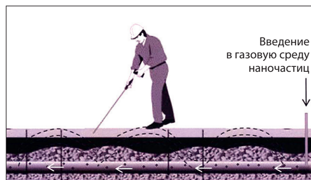
Рис. 2. Пример реализации способа определения положения полиэтиленового газопровода и мест возможных несанкционированных врезок
