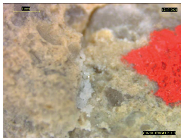
Рис. 3. Микрофотография образца бетона C16/20BG (добавка «Бетомикс-ИТХ Гель», 7 дней твердения) после механического разрушения и нахождения в воде 26 дней
