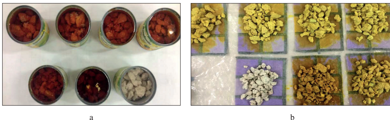
Рис. 2. Пропитка образцов щебня погружением в растворы «Аквастат» различной плотности в диапазоне от \rho = 1,17 \text{ г/см}^3 до \rho = 1,35 \text{ г/см}^3 : а – пропитка образцов щебня; б – внешний вид образцов
