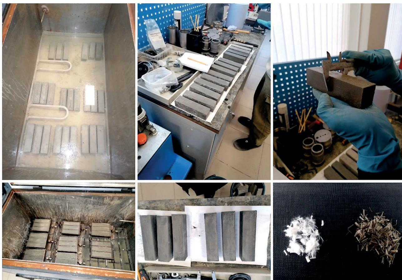
Рис. 1. Образцы тампонажных камней с различными свойствами
