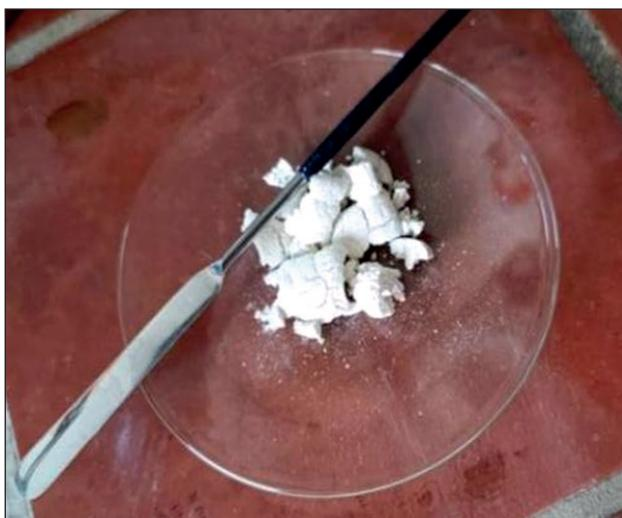
Рис. 1. Фотография добавки титаната висмута непосредственно после синтеза
