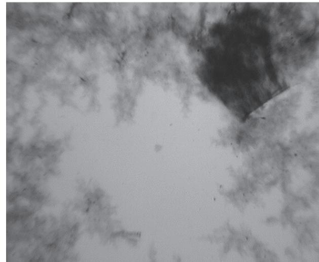
Рис. 1. Распределение УНТ в водной дисперсии гиперпластификатора ГП-60 (x5000)
