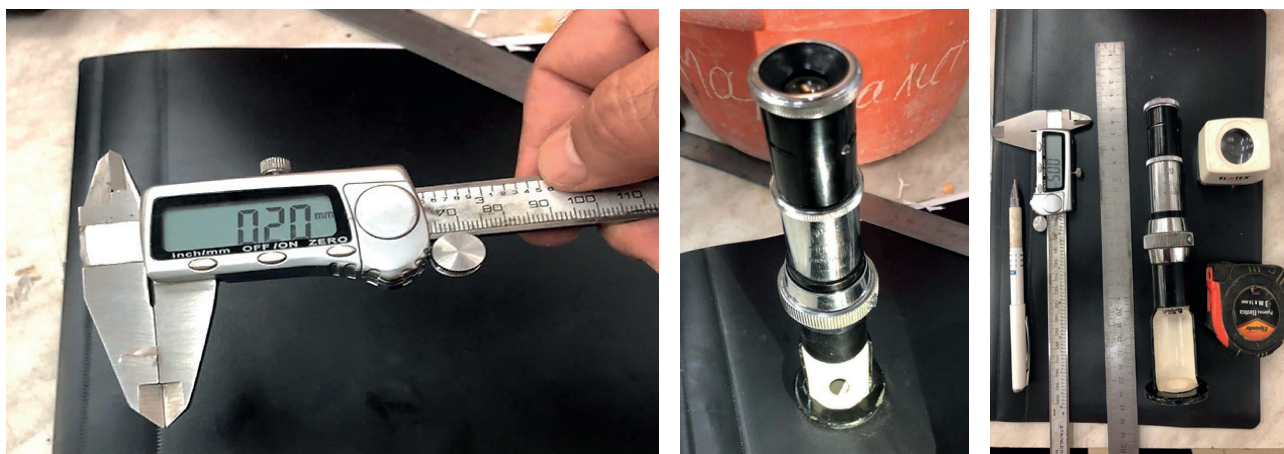
Рис. 5. Оборудование для определения геометрических размеров фибры
