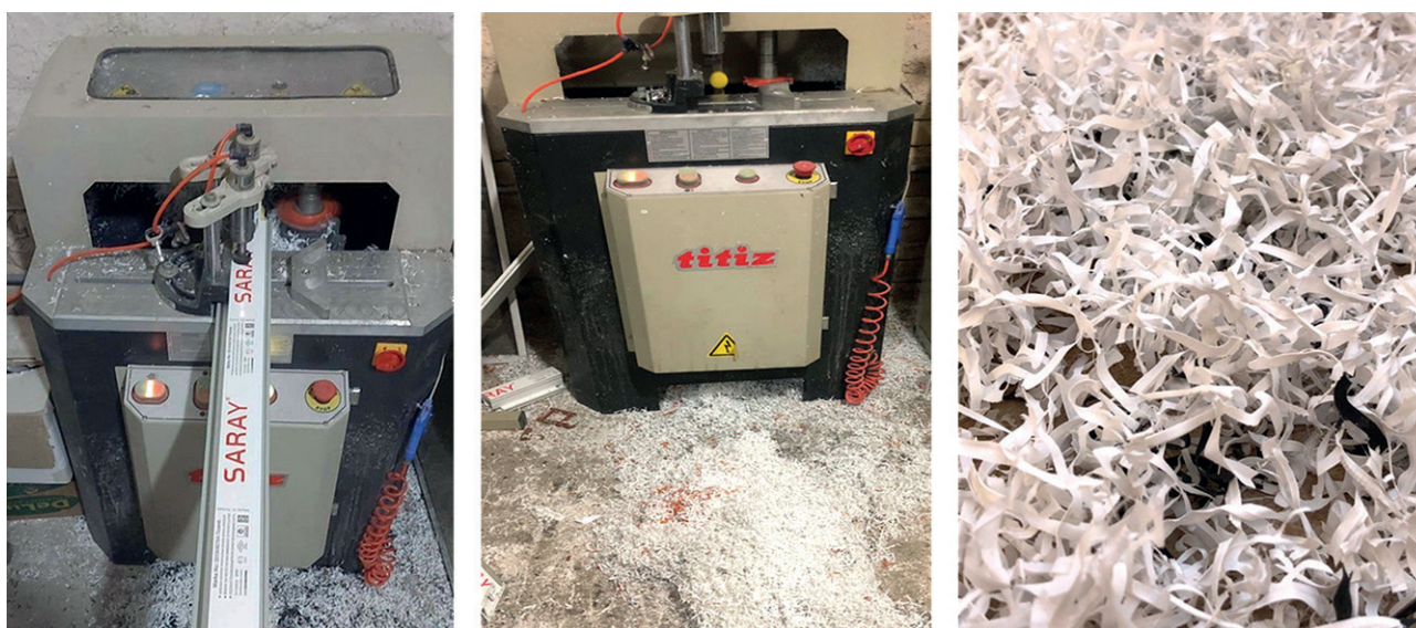
Рис. 4. Получение фибры в рубильной машине
