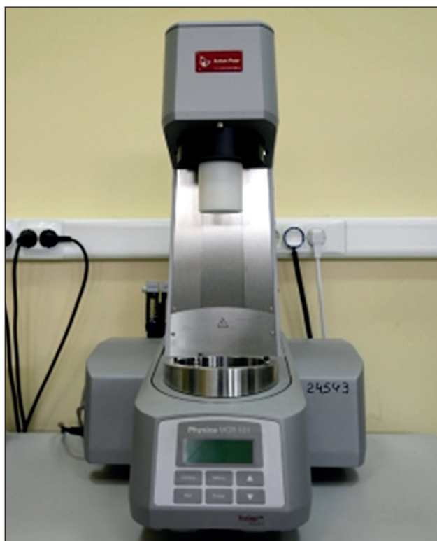
Рис. 1. Ротационный вискозиметр MCR 101 с измерительной системой «шар»
