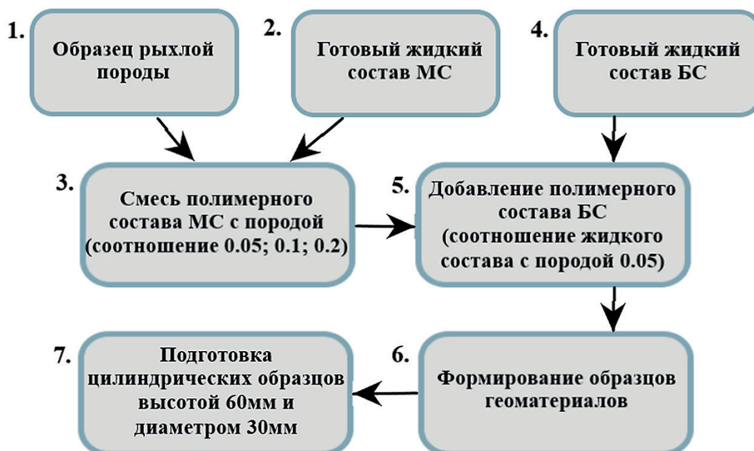
Рис. 2. Двухрастворный способ обработки песка полиуретановыми смолами: 1 – подготовка образца рыхлой породы; 2 – подготовка состава МС; 3 – смешивание жидкого состава МС с образцом рыхлой породы в соотношении 0,05; 0,1; 0,2; 4 – подготовка состава БС; 5 – добавление состава БС (объемное соотношение жидкая смола/порода равно 0.05) к смеси песка с составом МС; 6 – размещение смеси в цилиндрических формах диаметром 30 мм и высотой 80 мм, выдерживание до полного отверждения полимеров, извлечение образцов геоматериалов; 7 – подготовка геоматериалов для фильтрационных тестов: уменьшение высоты образцов до 60 мм
