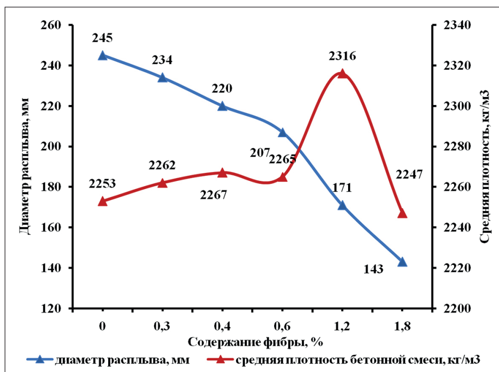
Рис. 9. Исследование влияния фибры на основе ПВХ на изменение диаметра расплыва мелкозернистого бетона
