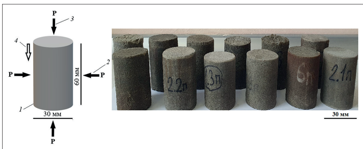
Рис. 3. Геоматериалы для фильтрационных экспериментов: 1 – цилиндрический образец геоматериала; 2, 3 – боковое и осевое сжатие образцов внешним давлением; 4 – направление фильтрации газа
