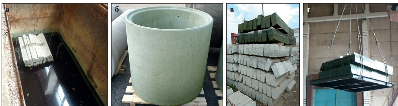
Рис. 11. Изображение схемы обработки полисульфидным раствором (а–г) бетонных бордюров и труб с использованием пропиточной ванны
