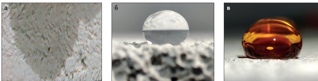
Рис. 9. Изображение капель воды на необработанном образце газобетона (а) и на образце газобетона, обработанном составом на основе полисульфида кальция: неокрашенная (б) и окрашенная (в) капли
