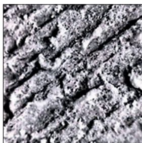
Рис. 1. Фотография поверхности теплообмена с нанесенным покрытием, а именно слой наночастиц оксида алюминия, нанесенный на микроструктуру
