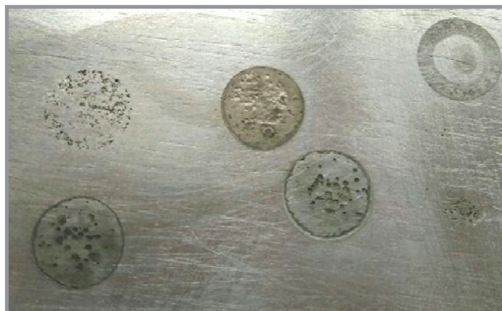
Рис. 2. Участки питтинговой коррозии на нержавеющей поверхности плакированного образца 09Г2С/08Х13 при различных значениях электродного потенциала (x100)
