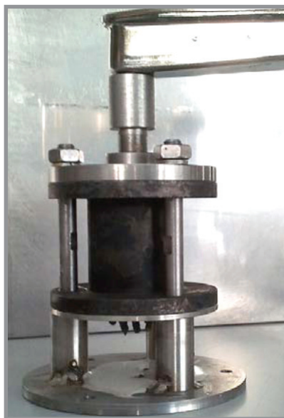
Рис. 2. Прибор для определения твердости керна
