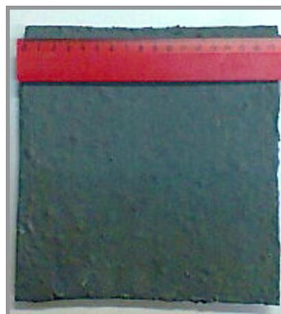
*Рис. 4. Внешний вид образца шунгитобетонной плитки*
