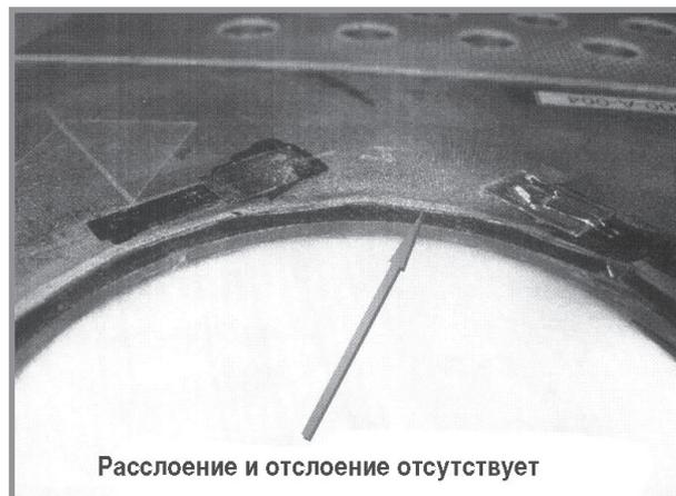
*Рис. 6.* Образец с упрочненным наноклеевой композицией отверстием после испытаний на сдвиг
