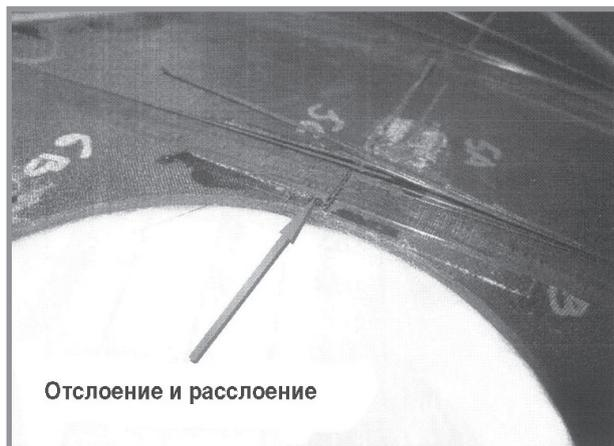
*Рис. 5.* Исходный образец после испытаний на сдвиг
