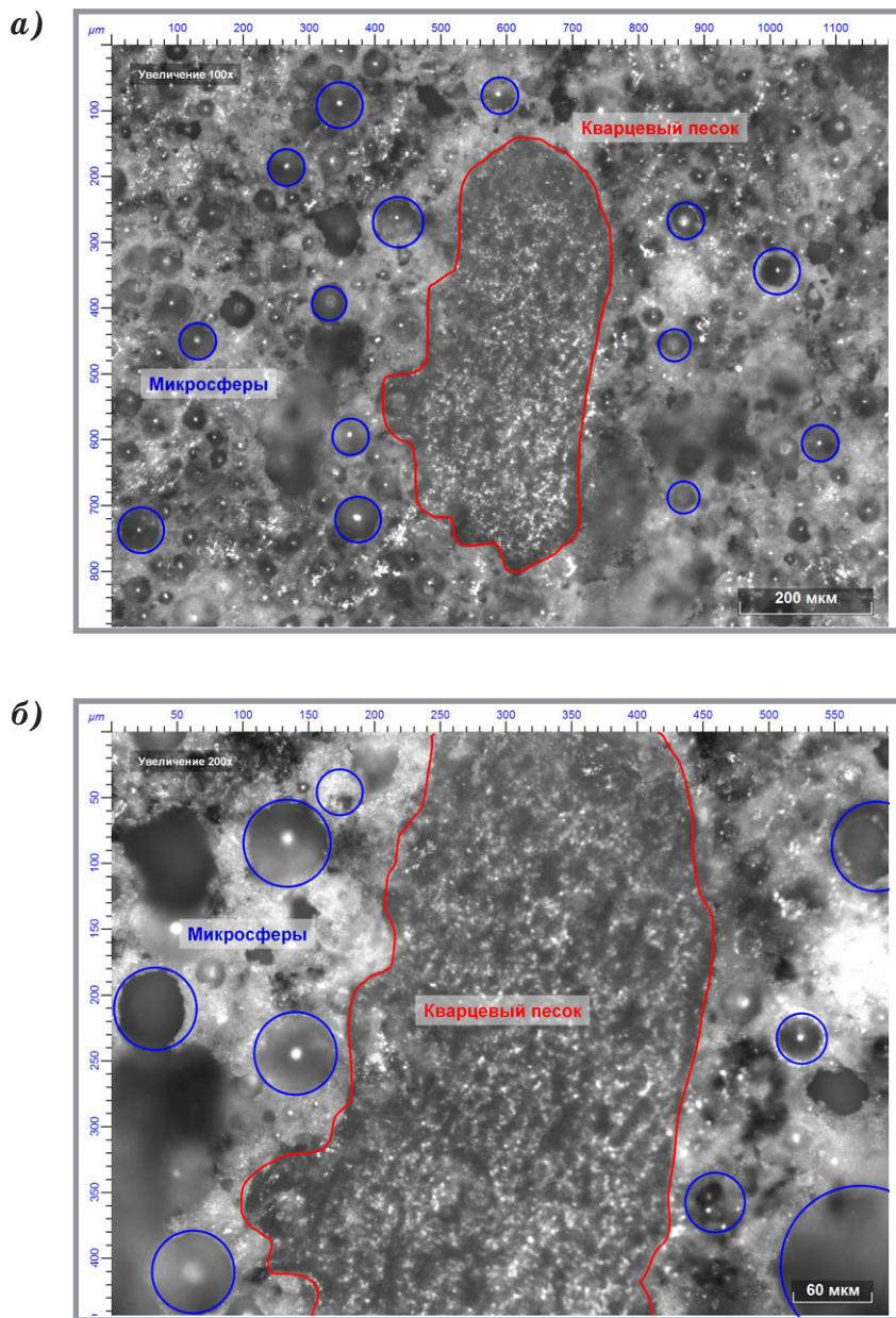
**Рис. 4. Микрофотография структуры наномодифицированных высокопрочных легких бетонов:**
