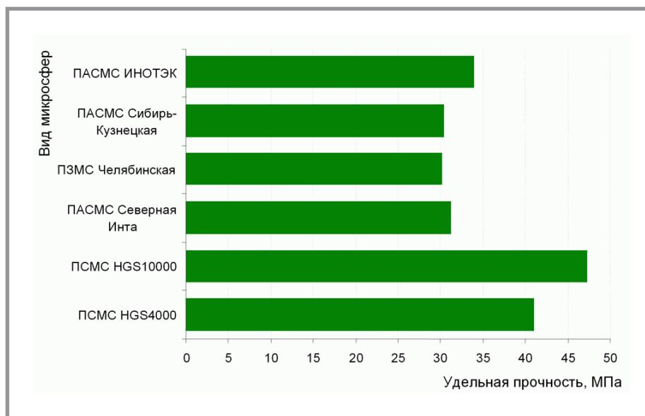
**Рис. 1. Влияние вида микросфер на удельную прочность высокопрочных легких бетонов:** ПСМС – полые стеклянные микросфераe; ПАСМС – полые алюмосиликатные микросфераe; ПЗМС – полые золомикросфераe
